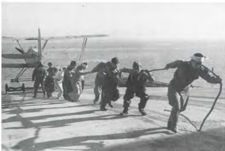
水上飛行機の引き揚げ 台車に乗せてロープで引っ張りあげる
