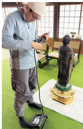
【写真6】ファイバースコープを用いた撮影の様子
